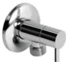
Robinet colțar cromat, cu cartuș ceramic VEGA (3/8" - pentru conectarea la baterie, 1/2", 3/4" - pentru conectarea la mașina de spălat)
