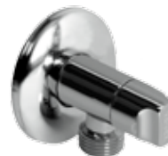
Robinet colțar cromat, cu cartuș ceramic STAR (3/8" - pentru conectarea la baterie, 1/2", 3/4" - pentru conectarea la mașina de spălat)
